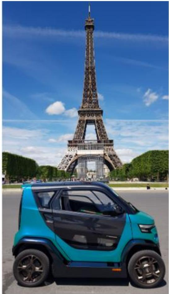
Con un **peso de 590kg**, en el que se incluye el paquete de baterías, su masa es un **80% menor** que en la mayoría de las baterías de vehículos eléctricos estándar. El CT-1 ofrece una **autonomía de 180km** en condiciones reales de **0 emisiones** y un **tiempo de recarga** de las baterías del 10 al 80% **de sólo media hora**. Asimismo, alcanza una **velocidad máxima de 90km/h**, y cuando se pliega a una anchura de un metro, la velocidad máxima se limita a 45km/h.
